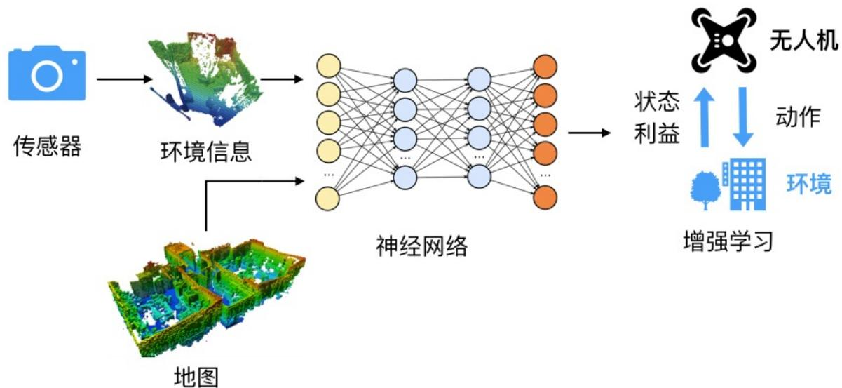
我们提出的导航方式如上图所示。其输入可以是一种或者多种机载传感器采集的数据，从而降低了算法对某种硬件的依赖，实现了不同机器人平台的兼容性。算法的输出是根据目的地自动规划的，没有障碍物的飞行路径。目前深度学习依靠构建拥有多层非线性变换的神经网络，在图像分类，物体识别等领域取得了巨大的成功。然而有监督的深度学习需要大量人工标注的数据集。增强学习关注机器人如何与环境互动来最大化预期利益，以学习完成任务的最优策略，所以将增强学习和深度学习结合可以消除对标注的依赖。
