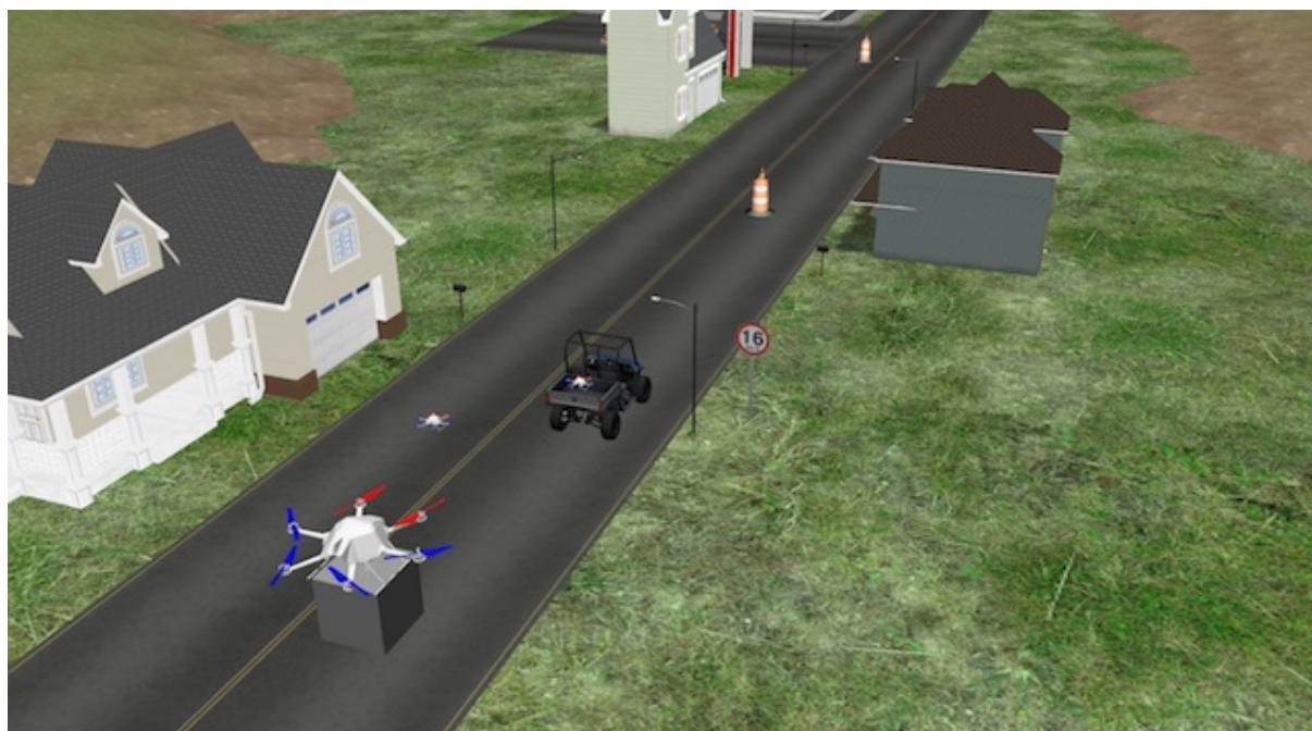
由于虚拟环境和真实环境的不同，不能直接把训练好的模型应用到现实当中。为了把知识迁移到底的无人机上，需要生成大量随机的虚拟环境，比如使用不同颜色的墙壁，改变障碍物的大小和纹理等。复杂多变的环境设置可以保证虚拟空间有足够的多样性，以应对现实中可能出现的光照变化，不同物体，多变场景等挑战。依据Levine, and Sadeghi, (2016)的研究，在多样化的模拟环境中训练好的模型可以直接用于真实环境。我们会在UCSD校园内的一个专门用于无人机飞行训练的场地内进行室外和室内环境的测试。
