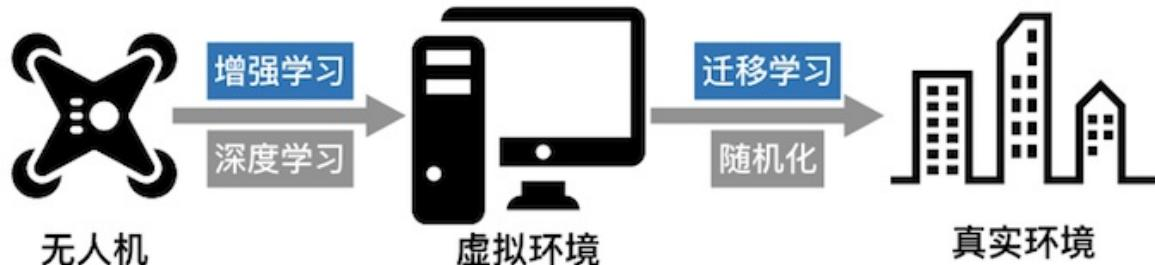
相比于传统导航方式，我们的方法只使用机载传感器，比如相机，惯性陀螺仪，激光雷达等来导航，不会发生信号丢失和被干扰的情况，所以这种导航技术可以应用于多种机器人平台(**兼容性**)，比如旋翼，固定翼等各种无人机类型，还包括无人车等。这种方法还能自动规划出无障碍路径(**安全性**)，不仅能应用于对稳定性要求很高的室外作业，比如城市中的快递运送，还能让无人机或无人车在室内运行，完成仓库内的运输等任务。使用相机等小型传感器还可以减小无人机的尺寸和载重负担，延长续航时间。
